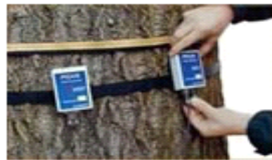
3) 幹に巻いたストラップにモジュールを取り付け、クギ頭に磁化センサーを取り付けます
