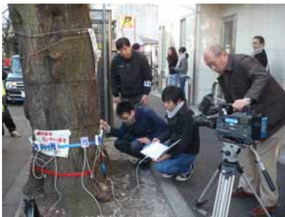
5) クギ頭に打撃子を取り付けハンマーで打撃子を軽くたたきます
